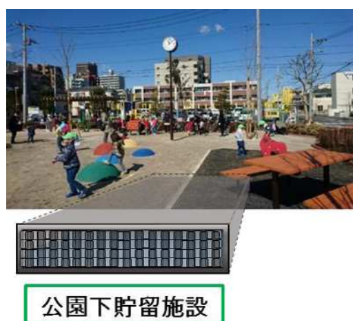
図 5.7 公園下貯留施設
