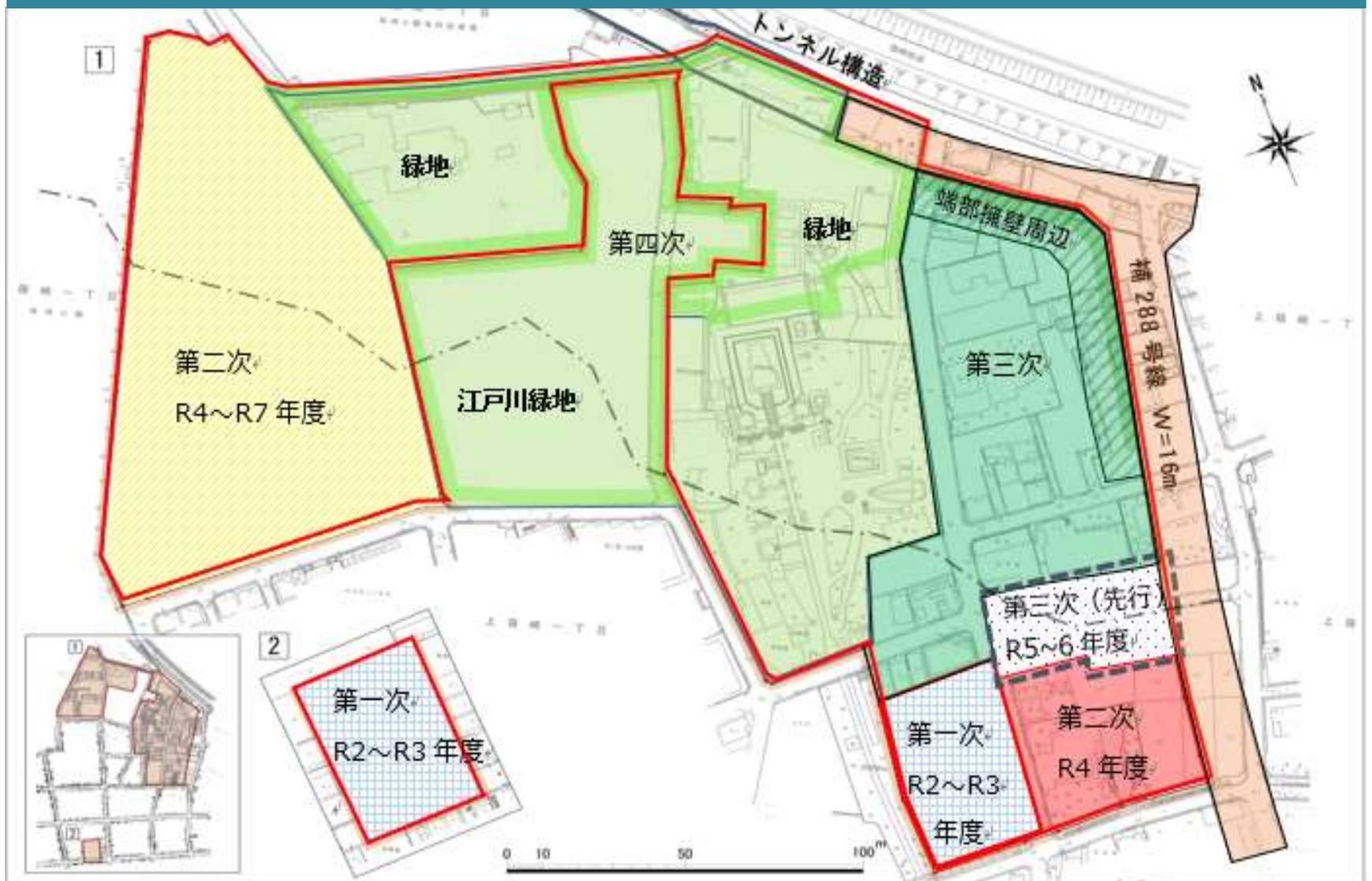
なお、令和5年度の工事は、西側の第二次地区において基礎撤去工事、ライフライン撤去工事、盛土等の工事を行い、第三次（先行）地区において基礎撤去工事、ライフライン撤去工事、造成工事等を行います。
