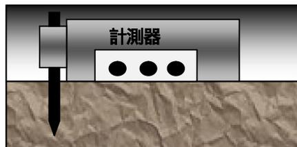
地盤内の湿潤密度が測定されます。そのことにより、土の水分量と乾燥密度が、わかるしくみとなっています。
