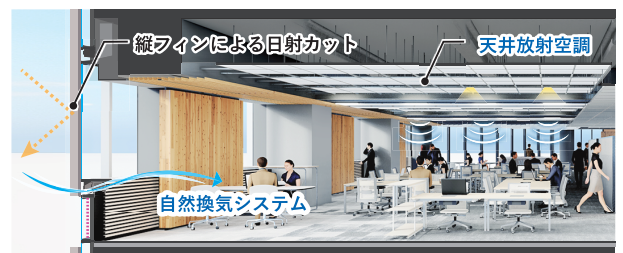
■ 熱負荷を効果的に取り除く天井放射空調と自然換気システム
