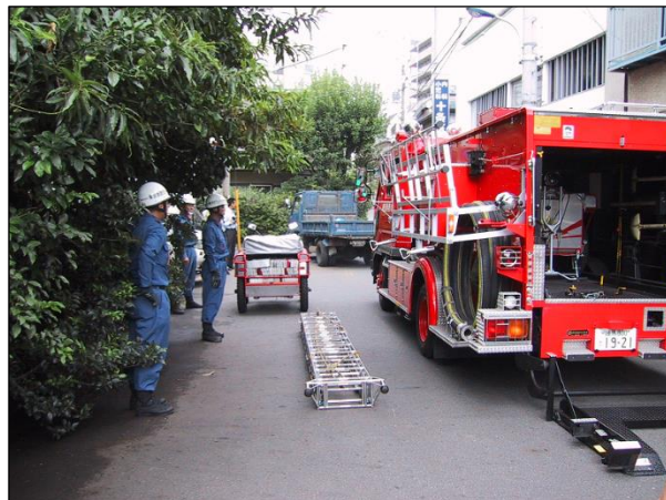
図20 幅員6mの道路 (ホースカーが自由に動ける)
