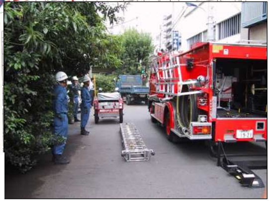
幅員 6 m の道路 (ホースカーが自由に動ける)
