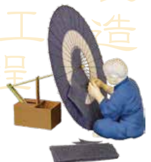
和傘製作工程模型「天井張り」
