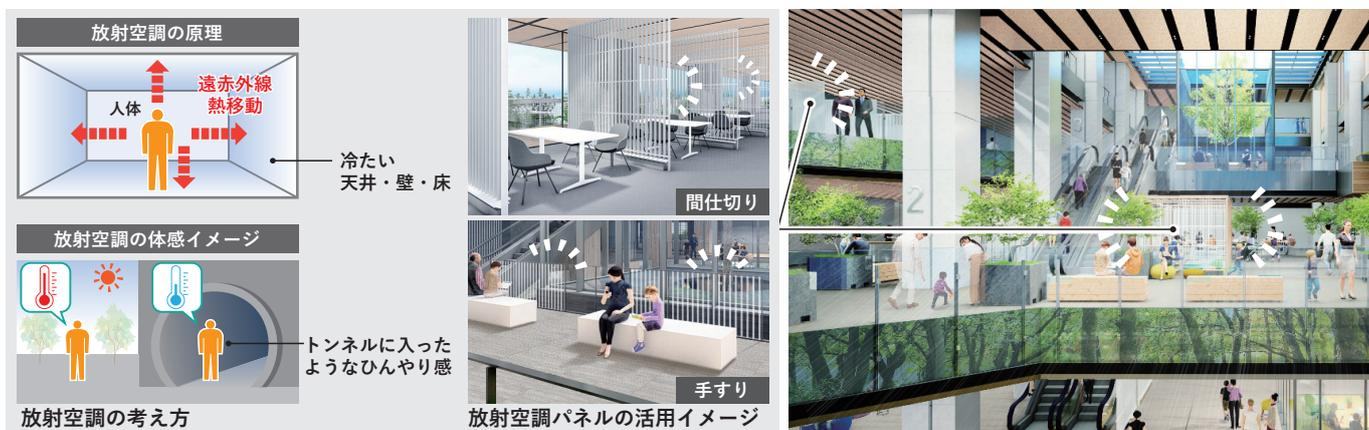
■ アトリウム広場のイメージ. 人の居場所の近くや吹抜け周りに放射空調パネルを設ける
