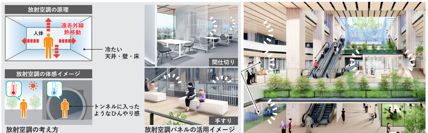
■ 協働・交流ゾーンのイメージ. 人の居場所の近くや吹抜周りに放射空調パネルを設ける
