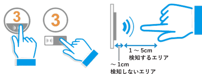
■ 手や指をかざすことでエレベーター操作を行う非接触式ボタンの例
