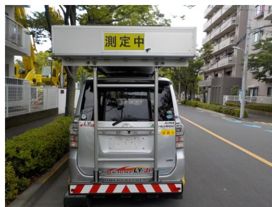
写真- 4.3 路面性状調査車両
