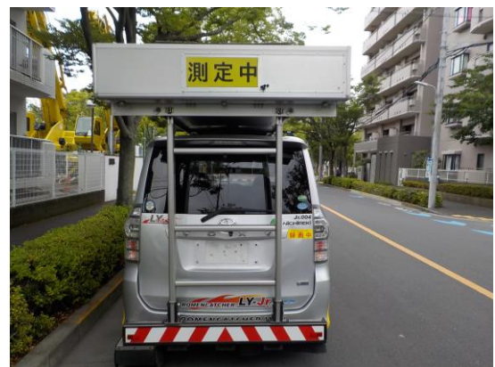
写真- 4.3 路面性状調査車両
