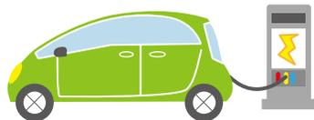
ガソリン自動車はガソリンをエンジンで燃焼させ、車を駆動させるのに対して、電気自動車は電動モーターで車を駆動させる。走行中にCO<sub>2</sub>や排気ガスを出さないといい環境面のメリットがある。
