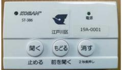
寸法 幅 115 mm 高さ 30 mm 奥行 70 mm
