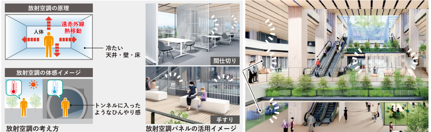
■ 協働・交流ゾーンのイメージ. 人の居場所の近くや吹抜周りに放射空調パネルを設ける
